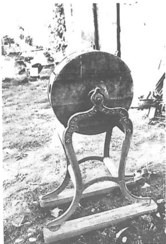
Sgranatrice per pannocchie di granturco, a "Jiti" (foto del 1974).
