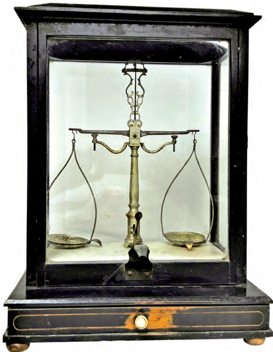
Fra le “chicche” del museo spicca questo bilancino di precisione dei primi decenni dell’800, integro, nella sua vetrinetta originale e completo di pesiera.
