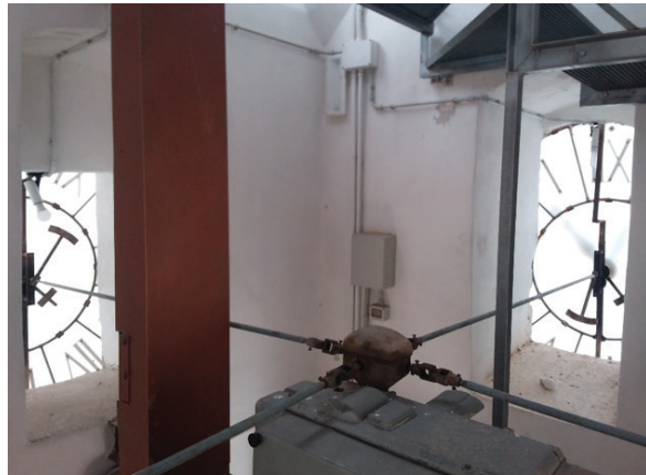
Fig. 69. Un quadrante della Torre dell'Orologio visto dall'esterno e dall'interno, il contrappeso che mantiene la carica e il meccanismo che fa scorrere le lancette dei quattro quadranti mantenendoli in sincronia.
